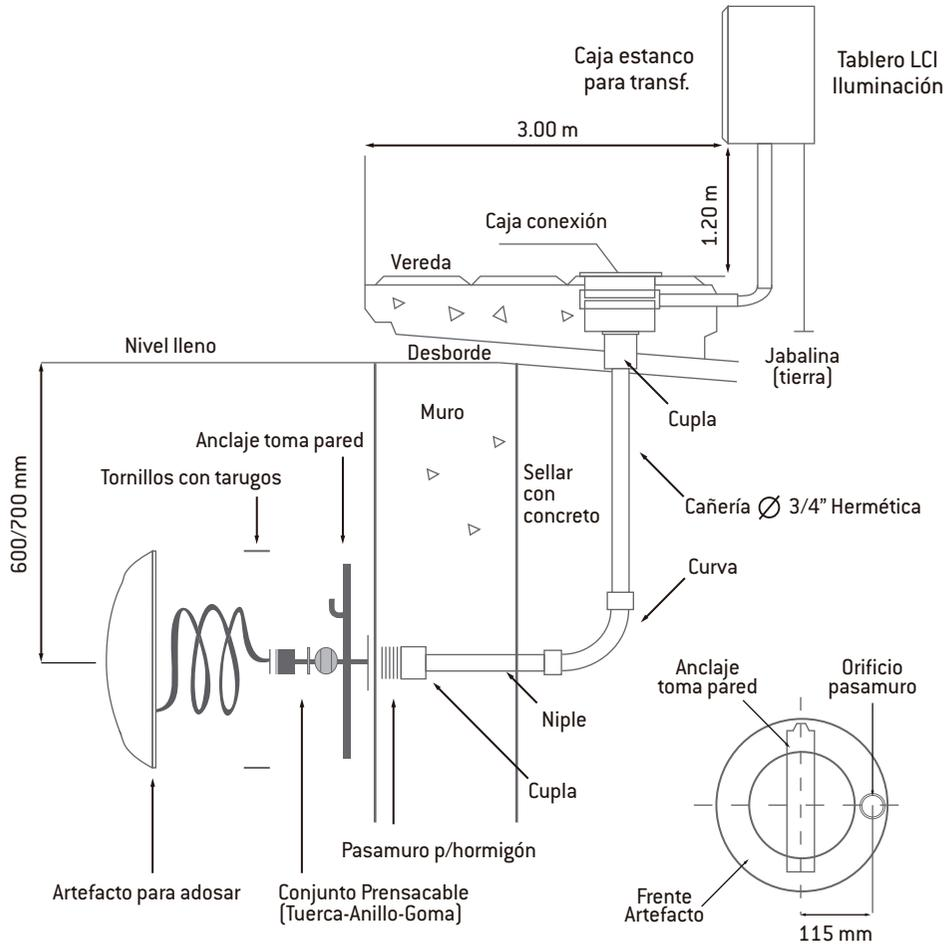
Fig. 1 - Instalación Hormigón/Mampostería
